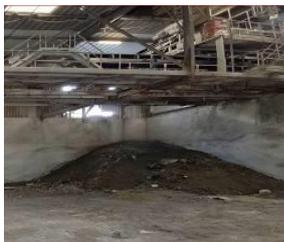
Les mâchefers sont les résidus d'incinération récupérés en sortie de four. Ils sont composés de verre, silice, alumine, calcaire, chaux, métaux ferreux et non-ferreux, sels, eau et composés organiques...
