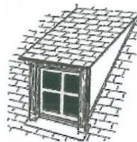
lucarne rampante ou en chien couché
