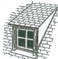
lucarne rampante ou en chien couché
