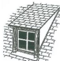
lucarne rampante ou en chien couché
