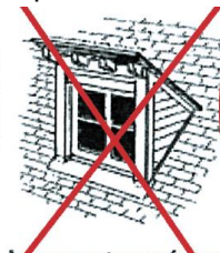
lucarne retroussée, ou demoiselle ; c'est aussi le vrai chien-assis
